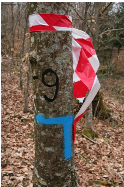
Exemple de marquage des points de référence du polygone limite : numérotation par chiffres négatifs (pour éviter les confusions avec les arbres de place), « T » de couleur bleue et bande plastique rouge et blanc.
